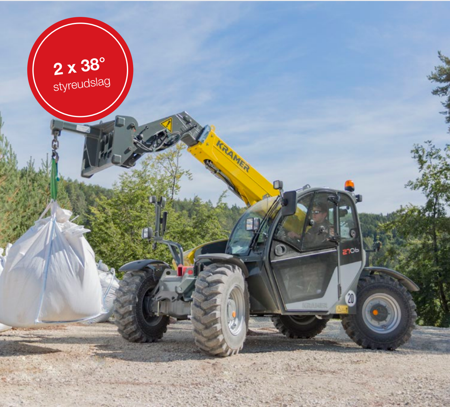
Firehjulsstyring: særligt manøvreedygtig ved begrænsede pladsforhold
