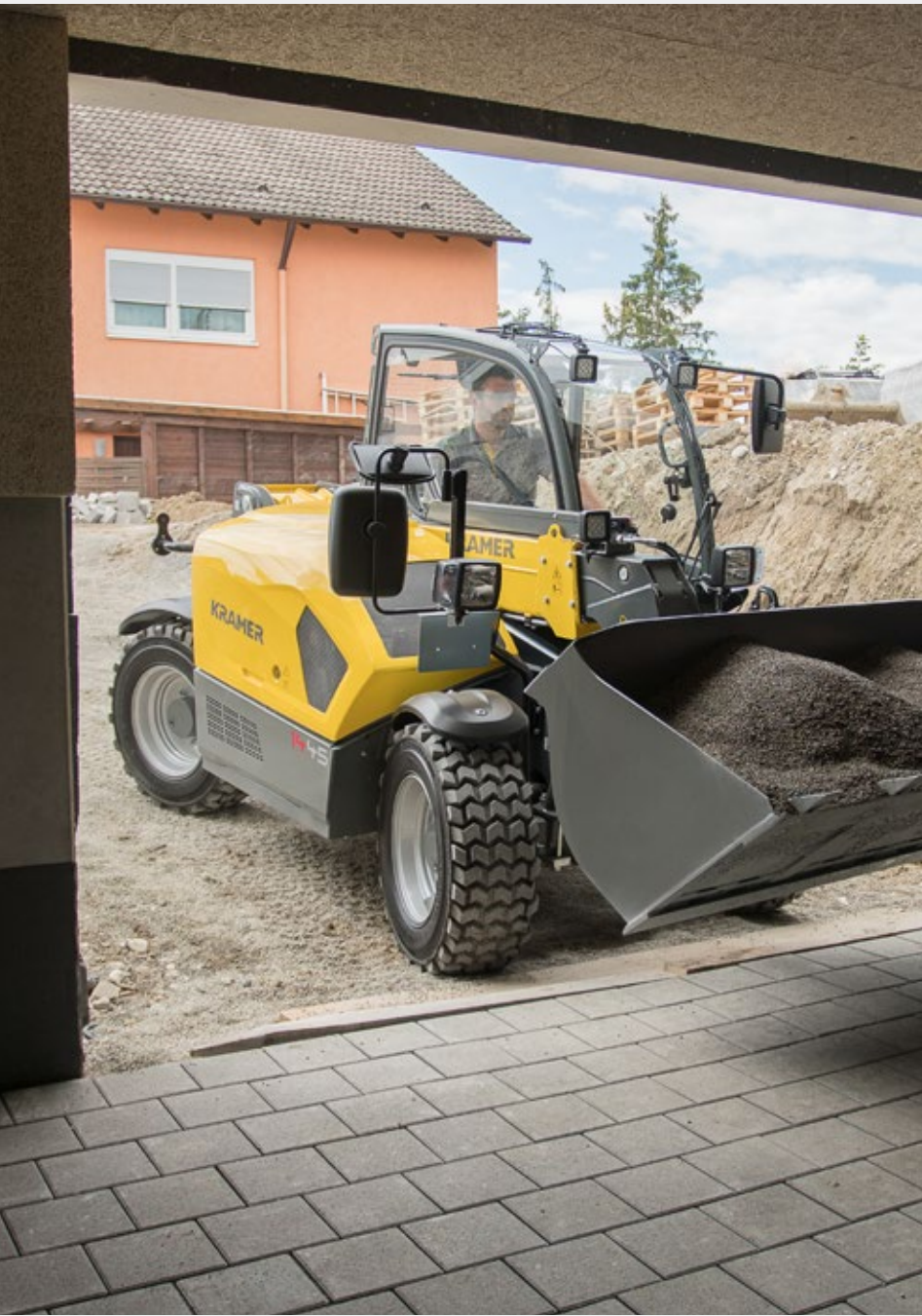
Lav konstruktionshøjde på under 2 m til vidt forskellige arbejdsopgaver
