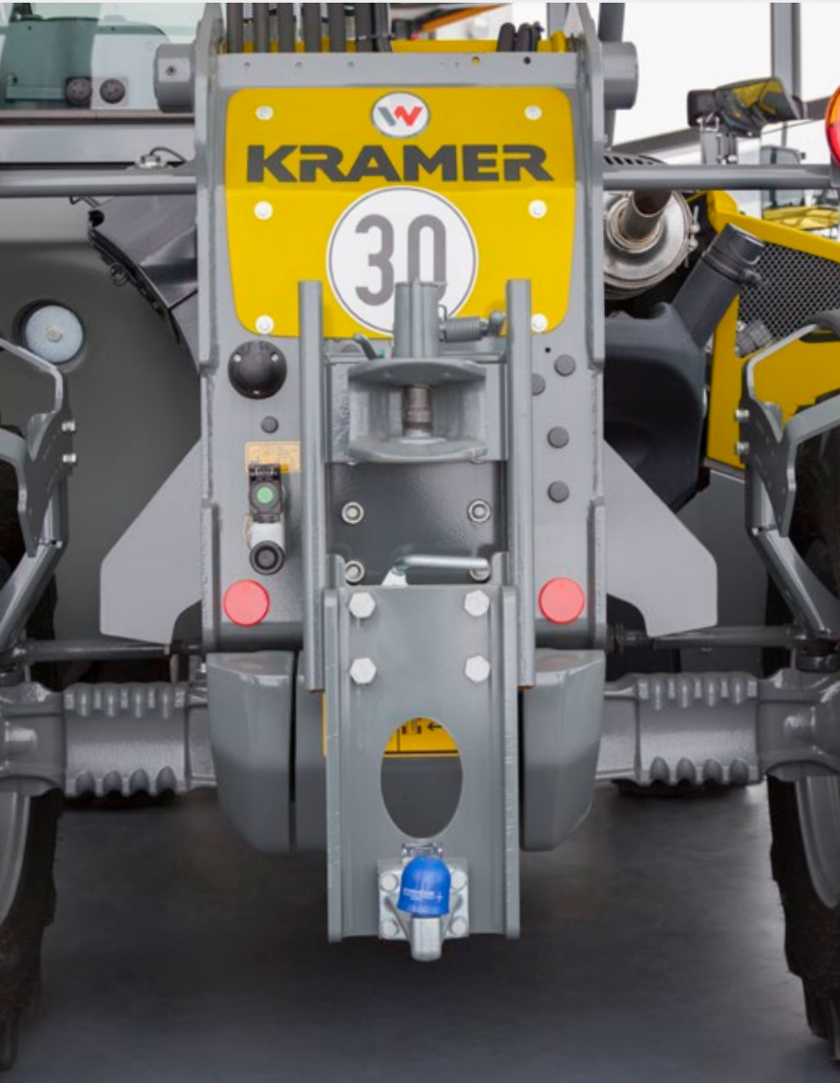
Eksterne betjeningslementer (2205 / 2706) til bagmonteret lift og kraftudtag.
