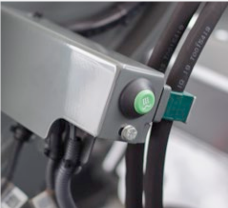
Trykaflastning 3. styrekreds: Nem til- og frakobling af arbejdsredskaber med hydrauliske ekstrafunktioner
