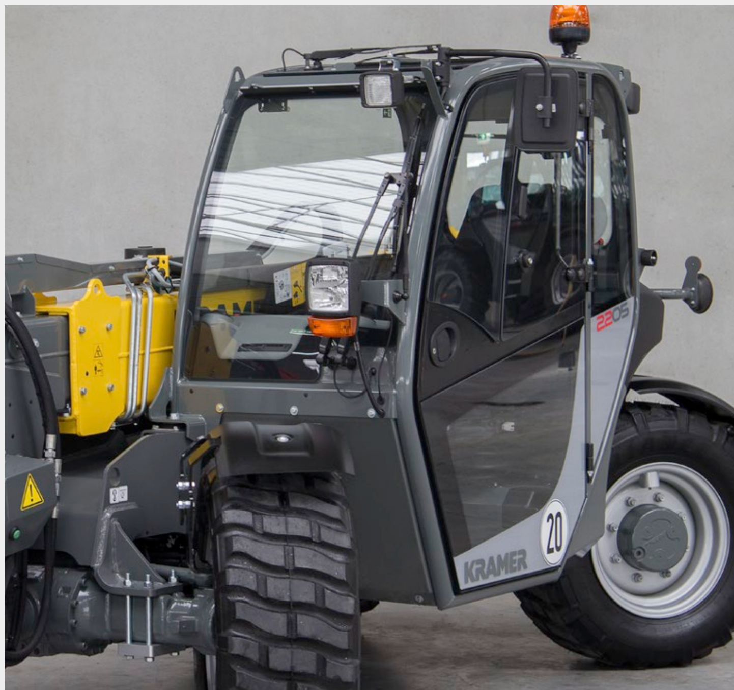
Fremragende panoramaudsyn: Smalle kabinesøjler giver et optimalt udsyn til alle sider.
